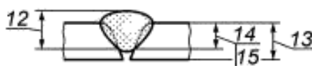
с) стыковой шов с неполным проплавлением Incomplete penetration butt weld Soudure avec manque de pénétration
