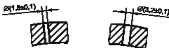
б — Сквозное отверстие
