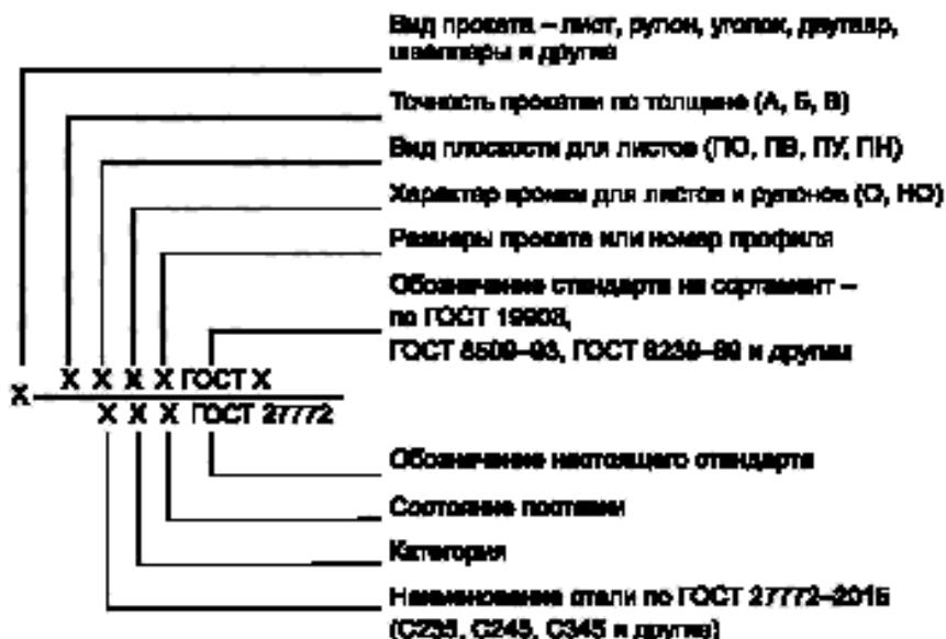
Прокат горячекатаный листовой повышенной точности (А), высокой плоскости (ПВ), с обрезной кромкой (О), размерами (10×1000×2000) мм по ГОСТ 19903, из стали С390, в улучшенном состоянии (У), категории 6:
